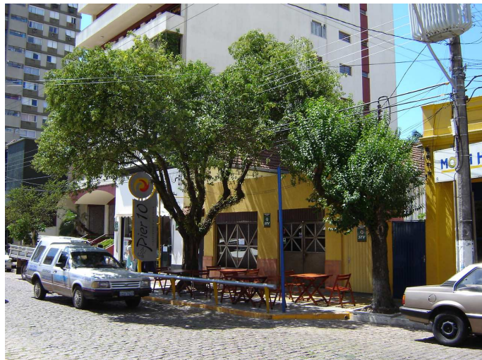
Copa atingindo a fiação elétrica.
