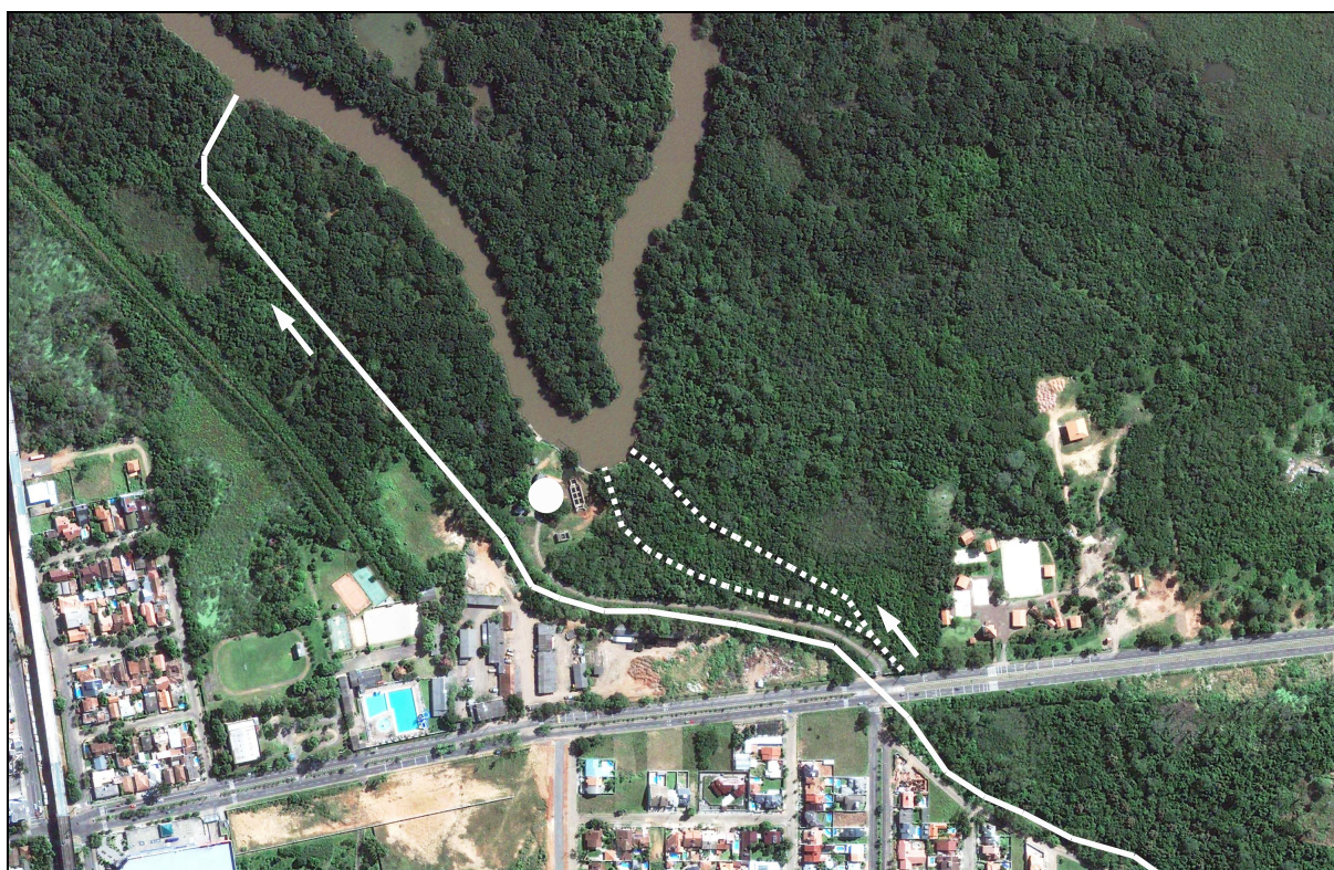
Figura III.15: Imagem representativa da alteração da foz do arroio Kruze. Linha pontilhada: antigo leito; linha contínua: leito atual; setas: sentido do fluxo; e círculo: local das bombas de captação de água do SEMAE. Adaptado da imagem de satélite Quick Bird. Fonte: Santos, 2007.
